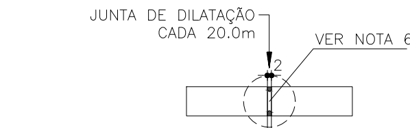
DETALHE 1 JUNTA DE DILATAÇÃO
